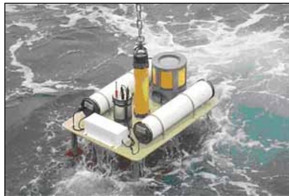
**Figure 2. Tsunameter BPR**
