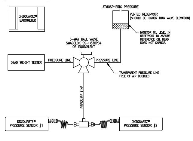
BLOCK DIAGRAM A-O-A TEST SYSTEM
